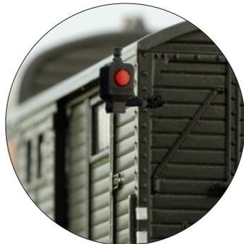
Besondere Beachtung verdient die Rückansicht mit der LED-Schlussbeleuchtung
